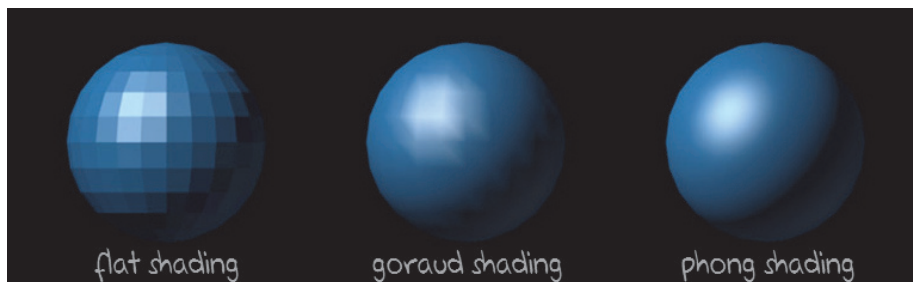
Abbildung 5.27: Werden die Ergebnisse der Verfahren gegenübergestellt, dann lassen sich die Unterschiede sehr gut erkennen. Mit dem Flat-Shading haben wir zwar das deutlich schnellste Verfahren, da die Beleuchtungsrechnung nur an einer Stelle stattfindet aber damit auch das qualitativ schlechteste. Das Phong-Shading wirkt sehr aufwändig, da wir für jedes Pixel die Beleuchtungsberechnung vornehmen, aber dafür erhalten wir einen sehr viel besseren visuellen Effekt.
