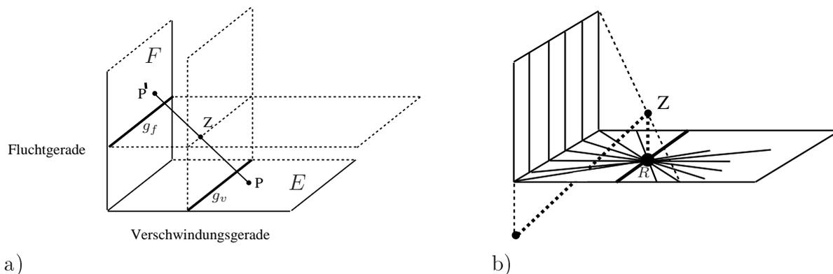
Figur 16.2: Zentralprojektion der Ebene  $E$  auf die Ebene  $F$  mit Zentrum  $Z$
