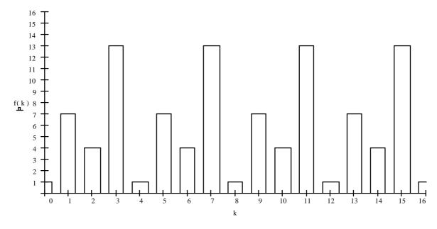
Auf der X-Achse befinden sich die steigenden Werte für k und auf der Y-Achse die entsprechenden Funktionswerte von  $f(k)=7^k \ mod \ 15$
